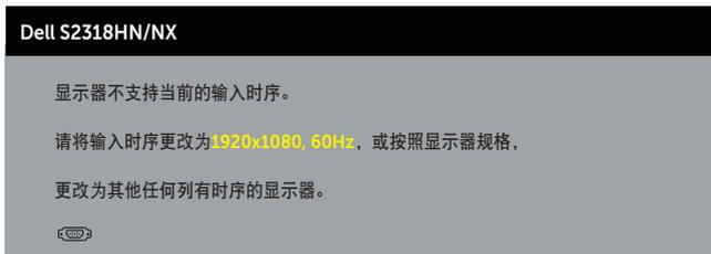
这表示显示器不能与它从计算机接收的信号同步。请参见[显示器规格](#)了解此显示器支持的水平和垂直频率范围。推荐模式是 1920 x 1080。
