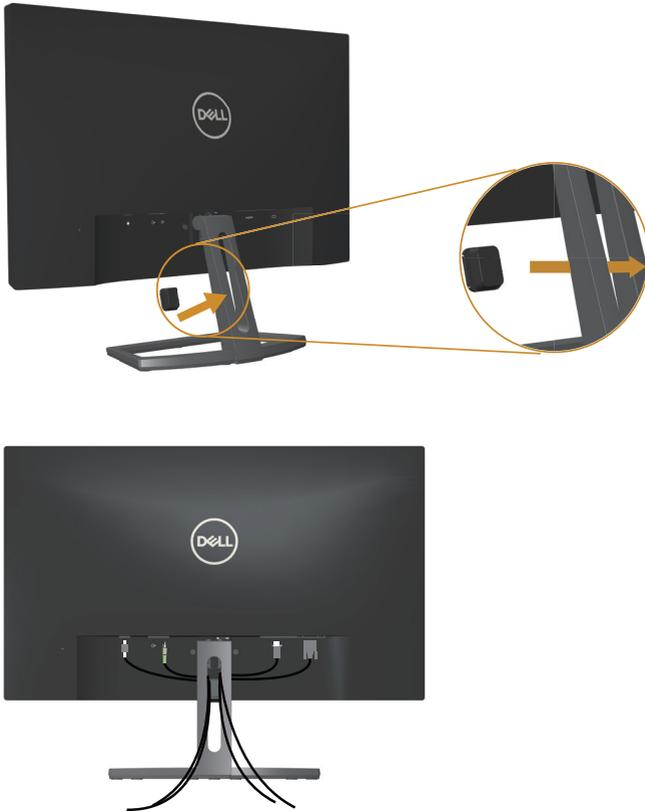
将所有必需的线缆连接至您的显示器和计算机，按上图所示整理所有线缆。
