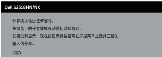
如果未连接 VGA 或 HDMI 线，会显示如下浮动对话框。显示器在此状态停留 4 分钟后进入节能模式。
